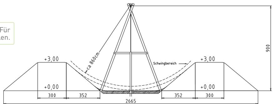
**Beschreibung:** 2 A-Stützen, aus je 2 Masten, mit Zopf Ø ca. 18 - 20 cm, 1 Schaukelbalken Mitlen Ø ca. 20 - 24 cm, mit Stahlprofil verstärkt, 2 Pendelsitze, an 6 mm Ketten, feuerverzinkt, Schlauchüberzug bis 2,5 m über dem Sitz, je 2 Abhängungen kugelgelagert, mit M 16 durchgeschraubt.
