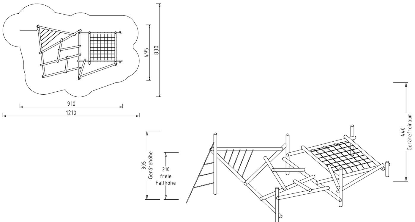
**Beschreibung:** Kletterkonstruktion aus 6 Stehern (Pfosten) aus Rundhölzern Ø 14 cm, und 15 Balancierhölzern, aus Rundhölzern Ø 14 cm, 1 Herkules-Flächennetz, 5 Herkules-Halteseile Ø 22 mm, 1 senkrecht�es Herkules-Dreiecksnetz Ø 16 mm.
