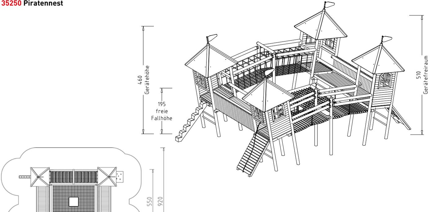
**Beschreibung:** 4 Vierecktürme, aus je 4 Rundhölzer Ø 12 cm, 4 Zeltäcker, Turmverschalungen mit Halbhölzern, 8 Fensteröffnungen, 2 Fixbrücken, 3 m lang, Außen-seiten mit senkrechter Halbh Holzverkleidung, 1 Wackelbrücke mit Zwischenstütze, 4 m lang, 1 Netztunnel mit Zwischenstütze 4 m lang, 4 verschiedene Aufstiege, 1 Flächen-netz, waagrecht, engmaschig, mit Netztrichter. Die 4 Türme des „Piratennests“, werden nach außen geneigt eingebaut.
