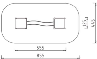
Beschreibung: 8 Steher (Pfosten) Rundhölzer Ø 12 cm, 2 MAXIMO Turmpodeste, aus je 2 Stahlwinkel, mit verdeckt geschraubtem Podestbelag 3,5/10 cm genutet, 4 Brüstungen schräg, 1 S-Hangelbahn, aus Formrohren, mit angeschweißten Hangelteilen aus Stahl-Rundrohr, verzinkt und rot pulverbeschichtet. Aufständerung mit 8 Stk. Doppellaschen. Fundamente: 8 Stk. 50x50x50 cm Gewicht: 160 kg, schwerstes Teil: 36 kg
