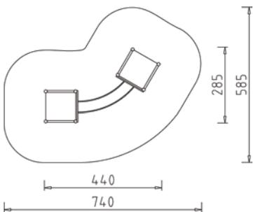
Beschreibung: 8 Steher (Pfosten) Rundhölzer Ø 12 cm, 2 MAXIMO Turmpodeste, aus je 2 Stahlwinkel, mit verdeckt geschraubtem Podestbelag 3,5/10 cm genutet, 4 Brüstungen schräg, 1 Kurven-Hangelbahn, aus Formrohren, mit angeschweißten Hangelteilen aus Stahl-Rundrohr, verzinkt und rot pulverbeschichtet. Aufständerung mit 8 Stk. Doppellaschen. Fundamente: 8 Stk. 50x50x50 cm Gewicht: 160 kg, schwerstes Teil: 36 kg
