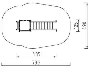
Beschreibung: 6 Rundsteher Ø 12 cm, 1 MAXIMO Turmpodest aus 2 Stahlwinkel, mit verdeckt geschraubtem Podestbelag 3,5/10 cm, 4 Handläufe aus Kantholz 7/7 cm, Eschensprossen Ø 4,5 cm, eingebohrt und verschraubt.
