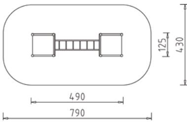
Beschreibung: 8 Steher (Pfosten) Rundhölzer Ø 12 cm, 2 MAXIMO Turmpodeste, aus je 2 Stahlwinkel, mit verdeckt geschraubtem Podestbelag 3,5/10 cm genutzt, 4 Brüstungen schräg, 1 Trapez-Hangelbahn, aus Formrohrrahmen, Trapez-Hangelteile aus Rundrohr, alle Stahlteile verzinkt rot und gelb pulverbeschichtet, Gleitlager.
