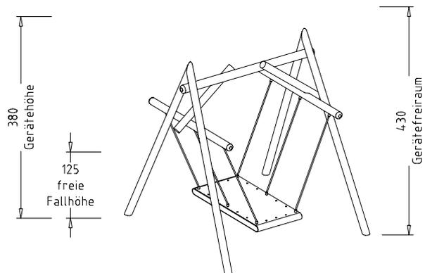
Beschreibung: 4 Steher (Pfosten) Ø 14 cm, durch 1 Querbalken Ø 16 cm miteinander verbunden, 2 Aussteifungen Ø 14 cm, 2 Schaukelbalken, 1 Schaukelpodest, Sitzfläche aus gewebeverstärktem Gummiband, mindestens 10 mm stark, mit stoßdämpfenden Gummischlaufen an beiden Enden, mit Kantholz-Rahmen verschraubt, 6 Ketten-Abspannungen, V-förmig, je 6 Schaukel-Gelenke oben und unten, kugelgelagert. Aufständigung mit 4 Stk. Doppellaschen.
