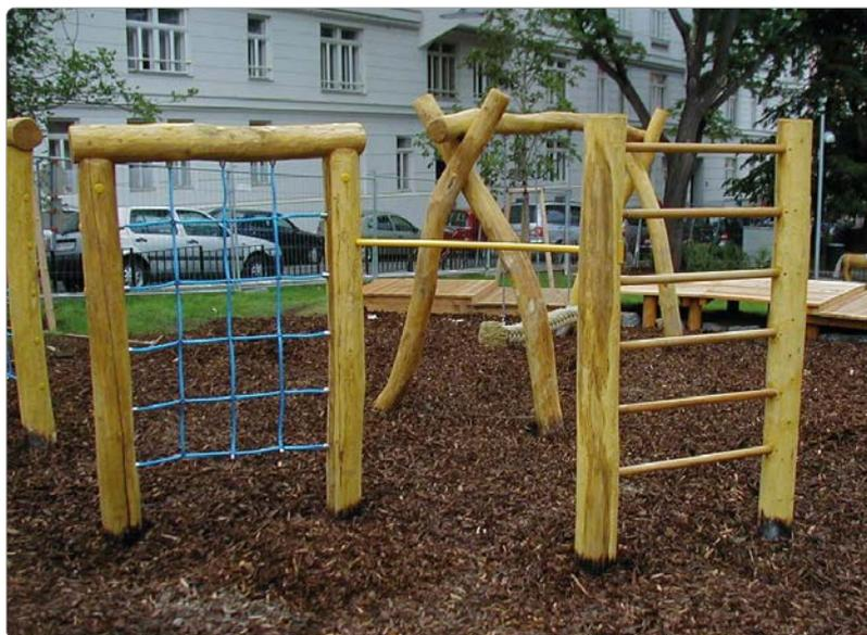
Beschreibung: 2 Kletterrahmen aus Rundhölzern Mindest Ø 14 cm, Eichensprossen Ø 4,5 cm, eingeböhrt und verschraubt, 1 Kletternetz senkrecht, 1 Reckstange aus Stahlrohr, verzinkt und gelb pulverbeschichtet, Schrauben Edelstahl.
