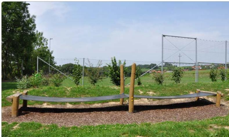
Beschreibung: 6 Steher (Pfosten), Rundhöler, Mindest  $\varnothing$  16 cm, 1 Gummiband mit Gewebereinlage, mind. 10 mm stark, an beiden Enden in Spannvorrichtungen verschraubt, an zwei mittig angeordneten Rundstehern ist 1 Rundrohr, verzinkt, waagrecht angeordnet, das kugelgelagert drehbar ist, Schrauben Edelstahl. Über die drehbare Rolle kann das Gummiband bei wechselnder Belastung gleiten.
