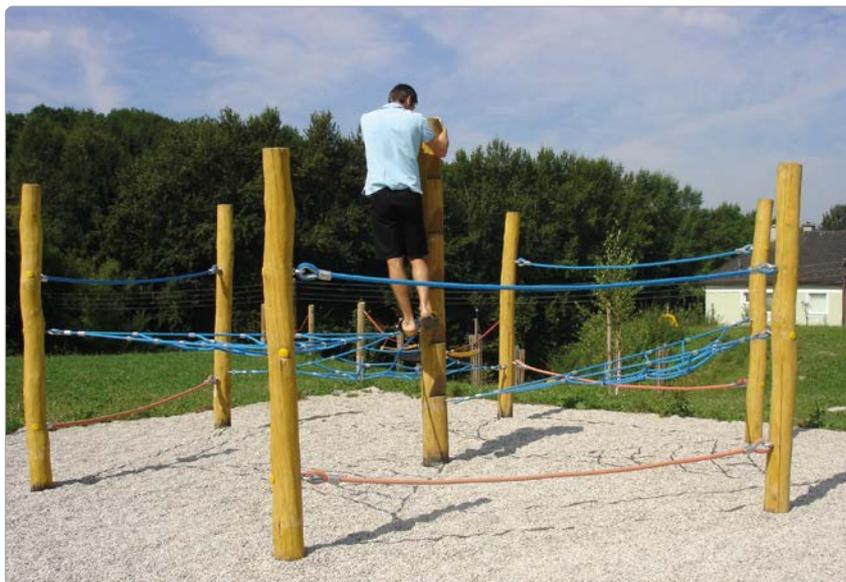
Beschreibung: 1 Kletterpfahl in der Mitte, mit Kletterkerben, 6 Steher (Pfosten), Mindest Ø 18 cm, 3 Herkules-Kletternetze schräg, je 3 Herkules-Balancier- und Haltetaue Ø 22 mm, Seilenden mit Gewindestiften M12 verspresst und durch die Holme geschraubt, Schrauben Edelstahl.
