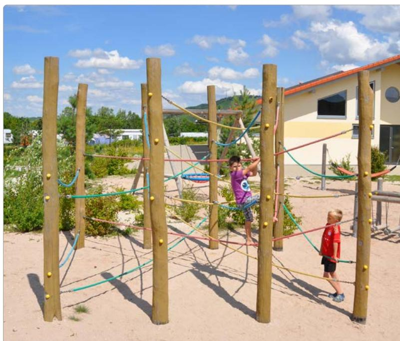
Beschreibung: 8 Steher (Pfosten) Mindest Ø 18 cm, Blanciertaue und parallel dazu Haltetaue, alle Ø 22 mm, aus Herkulestau, alle schräg gespannt, Seilenden mit Gewindestiften M12 verspresst und durch die Holme geschraubt, Schrauben Edelstahl.
