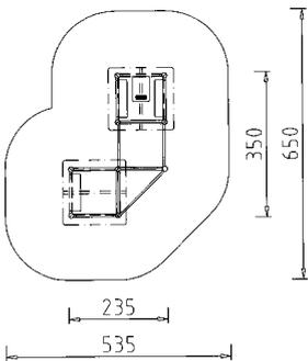
Beschreibung: 9 Rundsteher (-pfosten) Ø 12 cm, 3 Viereck-, 1 Dreieckpodest, MAXIMO-System, oder aus Siebdruckplatte mit Unterzügen 8 Handläufe, 8 Brüstungselemente, Inneneinrichtung bestehend aus 3 Bänken, 1 Tisch, aus Siebdruckplatten, 2 Giebeldächer.
