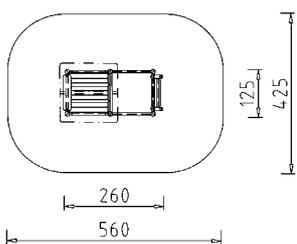
Beschreibung: 6 Rundsteher (-pfosten) Ø 12 cm, 1 Leiter, 2 MAXIMO Podeste, oder Siebdruckplatte mit Unterzügen, 5 Handläufe, 4 Brüstungselemente und 1 Kaufmannsladen, 1 Giebeldach, 1 Tisch, 2 Bänke aus Siebdruckplatte.
