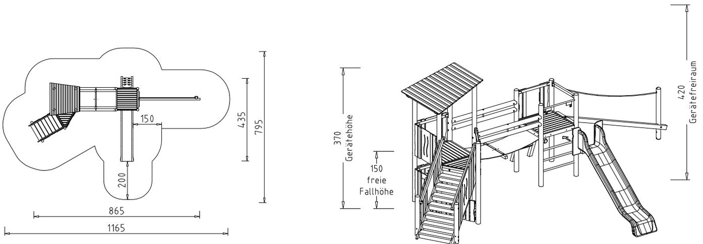
Beschreibung: 9 Steher, 2 Viereckpodeste, 1 Dreieckpodest, 4 Handläufe, 1 Pulldach aus profiliertem Schalung, 1 Leiter mit Absturzsicherung, 1 Balancierbalken-Aufstieg mit 1 Handlaufseil, 1 Treppe, 1 Absturzsicherung für Rutsche, 1 Gummibahnbrücke 2 m, 1 Spielpaneel mit Zahnrädern, 1 Spielwand nieder mit Sitzbank, 1 Spielwand Tante Emma Laden. Aufständigung mit 7 Stk. Doppellaschen, 5 verdeckte Aufständigungen, 2 Stk. Eisenschuhe für Aufstiege.
