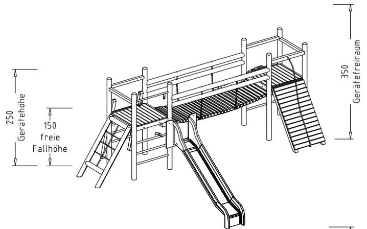
Beschreibung: 8 Steher, 2 Podeste, 5 Handläufe, 1 schiefe Ebene mit Hangeltau, 1 Netzaufstieg mit Rahmen, 1 Stufenbaum, 1 Wackelbrücke 3 m, 1 Absturzsicherung für Rutsche.
