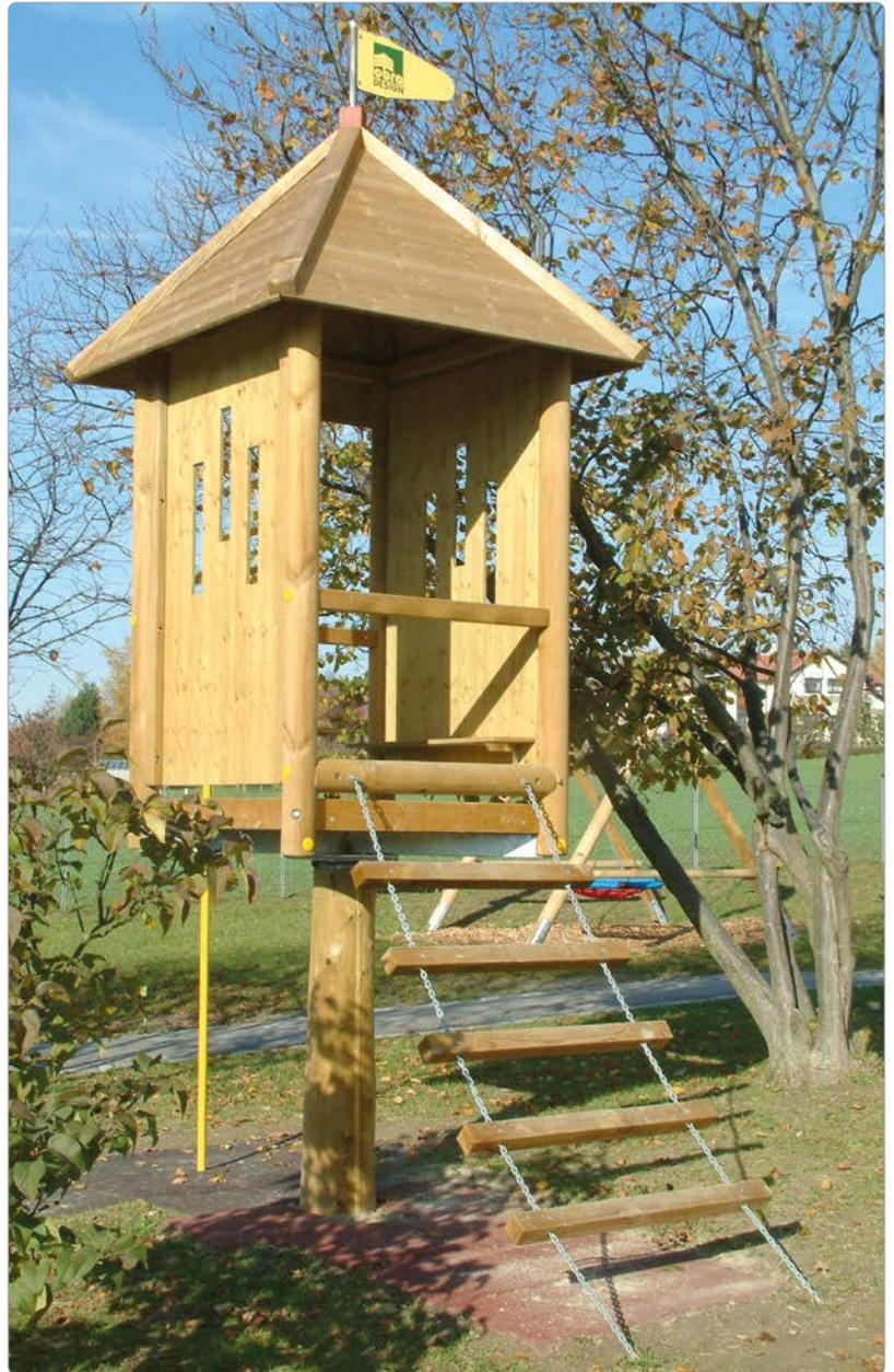
Beschreibung: Das Baumhäuschen wird über 1 Stk. Stahl-Formrohr-Steher aufgebaut. Der Formrohrsteher wird mit 4 Stk. gerundeten Schwarten verkleidet. Das Baumhäuschen besteht aus 4 Rundsteher Ø 12 cm, 1 Turmpodest, 2 Seitenwänden und 1 Zelt Dach. Der Aufstieg erfolgt über 1 Balken-Ketten-Aufstieg und 1 Feuerwehr-Kletterstange.
