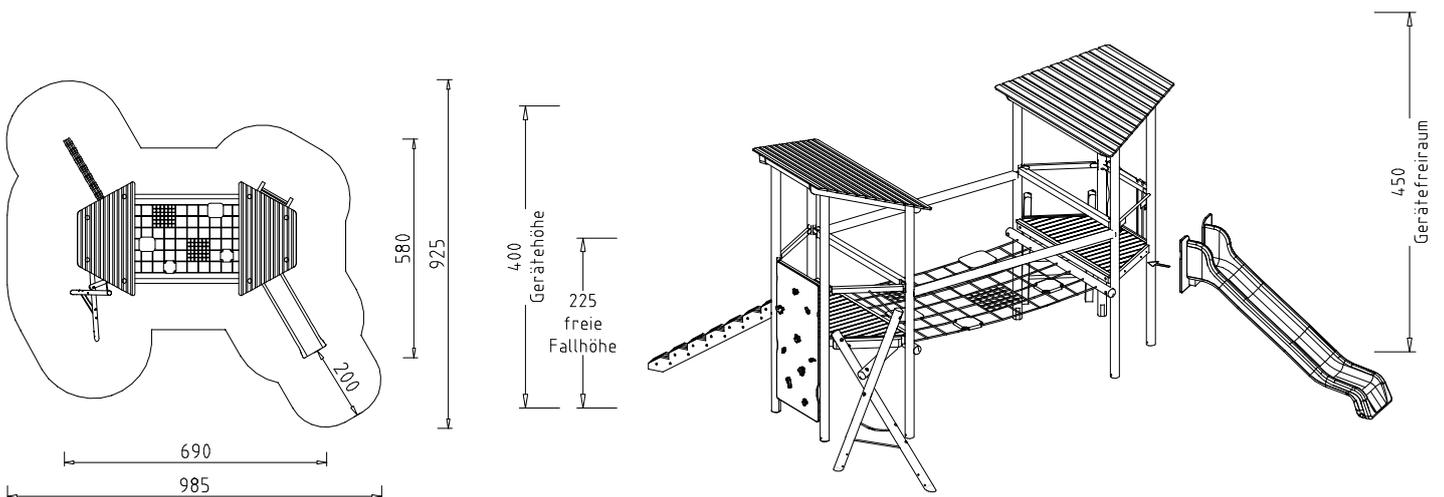
Beschreibung: 8 Steher, 2 Trapezpodeste, 7 Handläufe, 1 Brüstungselement, 1 Absturzsicherung für Rutschen, 2 Pultdächer aus profilierter Schalung, mit Sparren und Pfetten, 1 Leiter, 1 Stufenbaum, 1 Herkules-Flächennetz waagrecht zwischen den Türmen, mit diversen Einsätzen, 1 Stangen-Kletter-Aufstieg, 1 Bergsteiger-Kletterwand senkrecht.
